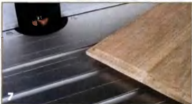
7 На задней стороне филенок выбирают четверти размером 6 мм.
