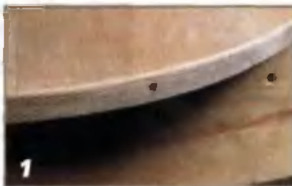
Отметки подпалин из-за перегрева фрезы, работающей на пониженных оборотах.
