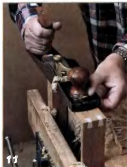
Чтобы продемонстрировать аккуратные соединения, прострогайте боковые стороны рамки.
