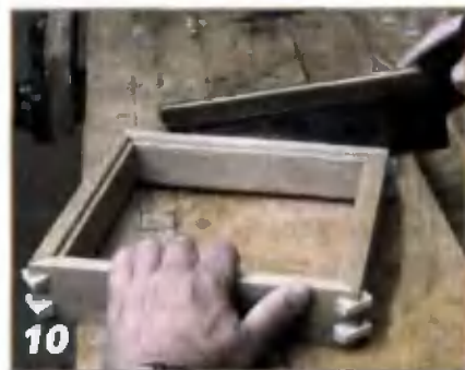
Вклеив шпонки, отпилите их заподлицо с рамкой.
