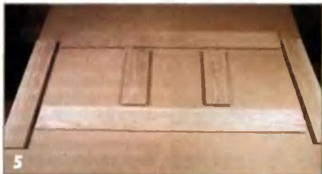
5 При подгонке к соединению на «бисквитах» детали рамы раскладывают на листе ДВП.
