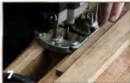
Проставка, вставленная между фрезером и «линейкой», нужна для выборки второго паза.
