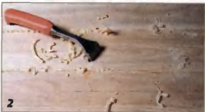
Полиэфирный клей обеспечивает хорошее прочное соединение. После застывания лишний клей легко чистить.
