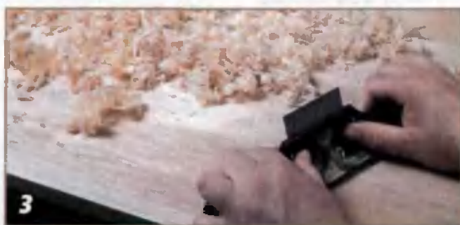
Обычная цикля портит твердую древесину дуба, поэтому лучше циклевать так называемым «крылом чайки» — циклей с двумя ручками.
