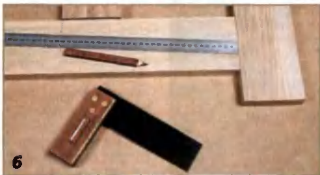
6 Так как «бисквитные» соединения могут «играть» по углу, положение деталей размечают так, чтобы их можно было подправить.
