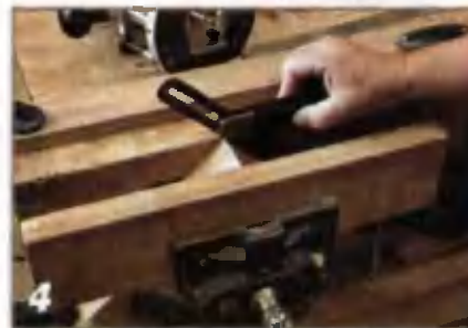
Рамку, стянутую лентой, зажмите в тисках и проверьте ее положение (угол должен быть равен 45°).
