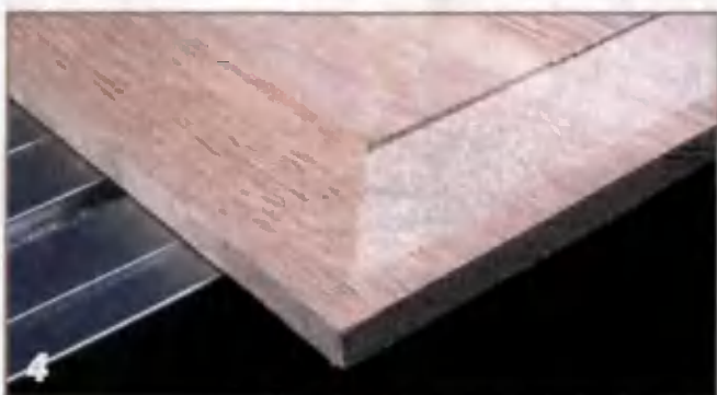
После продольного распиливания панели опилены по ширине на качающейся усовочной пиле.
