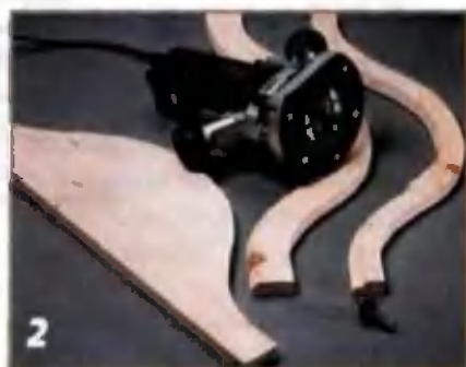
Кромки дугообразных элементов обрабатывают фасонной фрезой с упорным подшипником.
