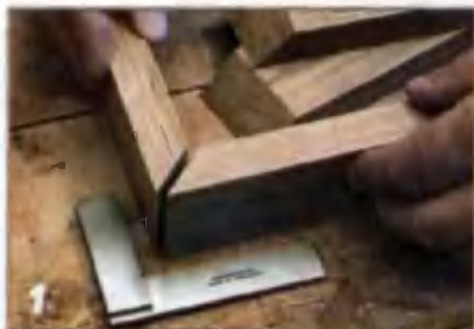
Для проверки подгонки угла 90° сведите запиленные «на ус» концы.
