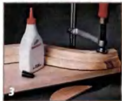
До высыхания клея «кокошник» должен быть стянут струбцинами.
