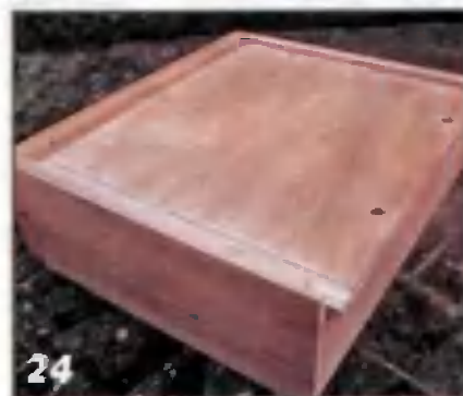
24 Дно выдвижного ящика крепят только к задней стенке.
